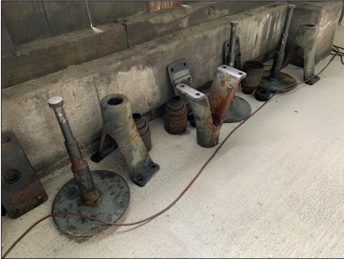
Die Puffer sind bereit für die Sandstrahlung und den Neuanstrich.
